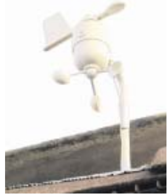
Dieses Gerät auf dem Dach misst die Windstärke.
